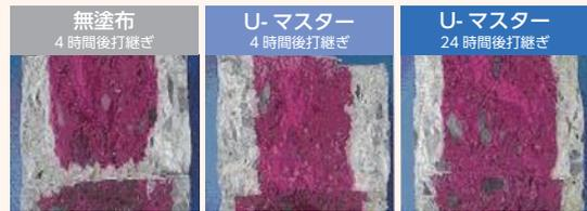
旧コンクリート打設後、表面処理無しで、4時間後に新コンクリートを打継ぐ。
